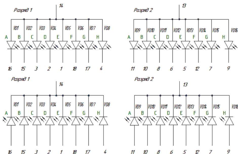
Рисунок 4 – Схема электрическая принципиальная на индикаторы КИПЦ57А-2/7, КИПЦ57А1-2/7
