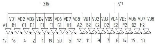
Схема включения с общим анодом (ИПЦ53A9-2/7)
