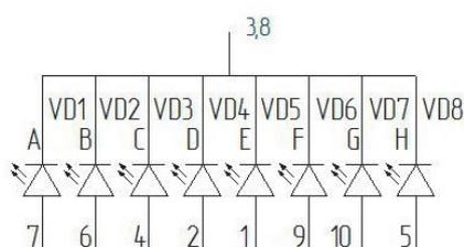
Схема включения с общим катодом (ИПЦ54А91-1/7)
