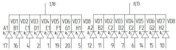
Схема включения с общим катодом (ИПЦ53A91-2/7)
