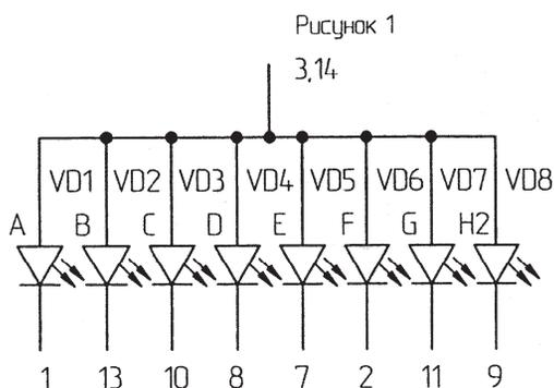
Схема электрическая с общим катодом
