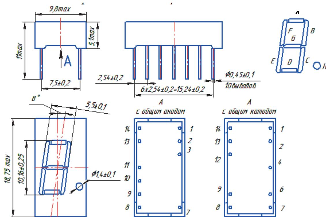
Рисунок 1 – Габаритный чертеж на индикаторы КИПЦ56А-1/7, КИПЦ56А1-1/7
