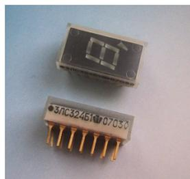
Нумерация выводов показана условно «Точка» на корпусе обозначает начало отсчета выводов
