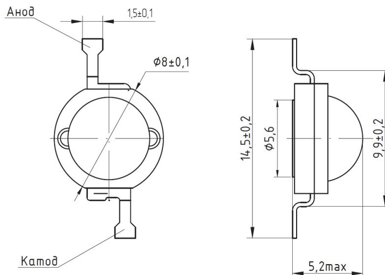
Излучатели соответствуют АДКБ.432220.510 ТУ. Предназначены для создания излучения инфракрасного диапазона.
