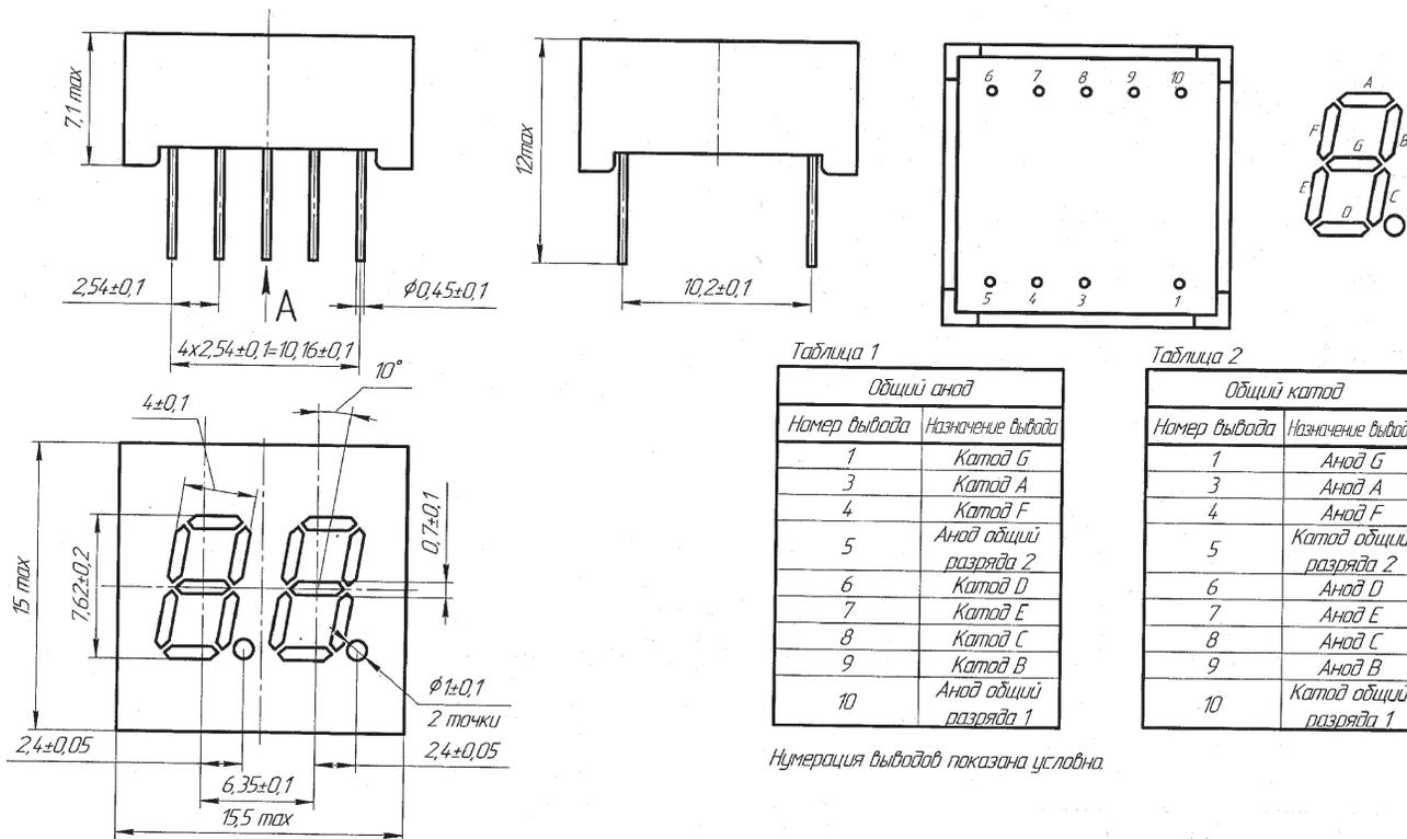
Схема электрическая с общим анодом
