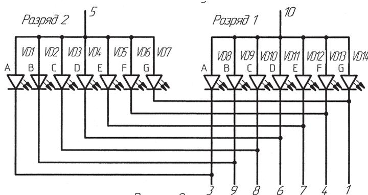
Схема электрическая с общим катодом
