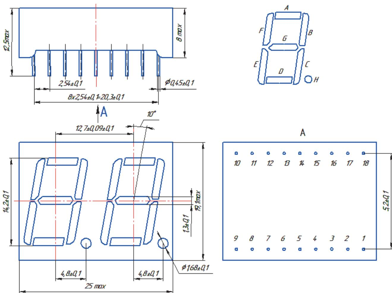
Рисунок 3 – Габаритный чертеж на индикаторы КИПЦ57А-2/7, КИПЦ57А1-2/7
