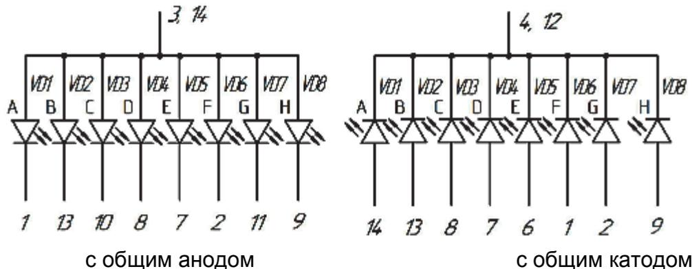
Рисунок 2 – Схема электрическая принципиальная на индикаторы КИПЦ56А-1/7, КИПЦ56А1-1/7
