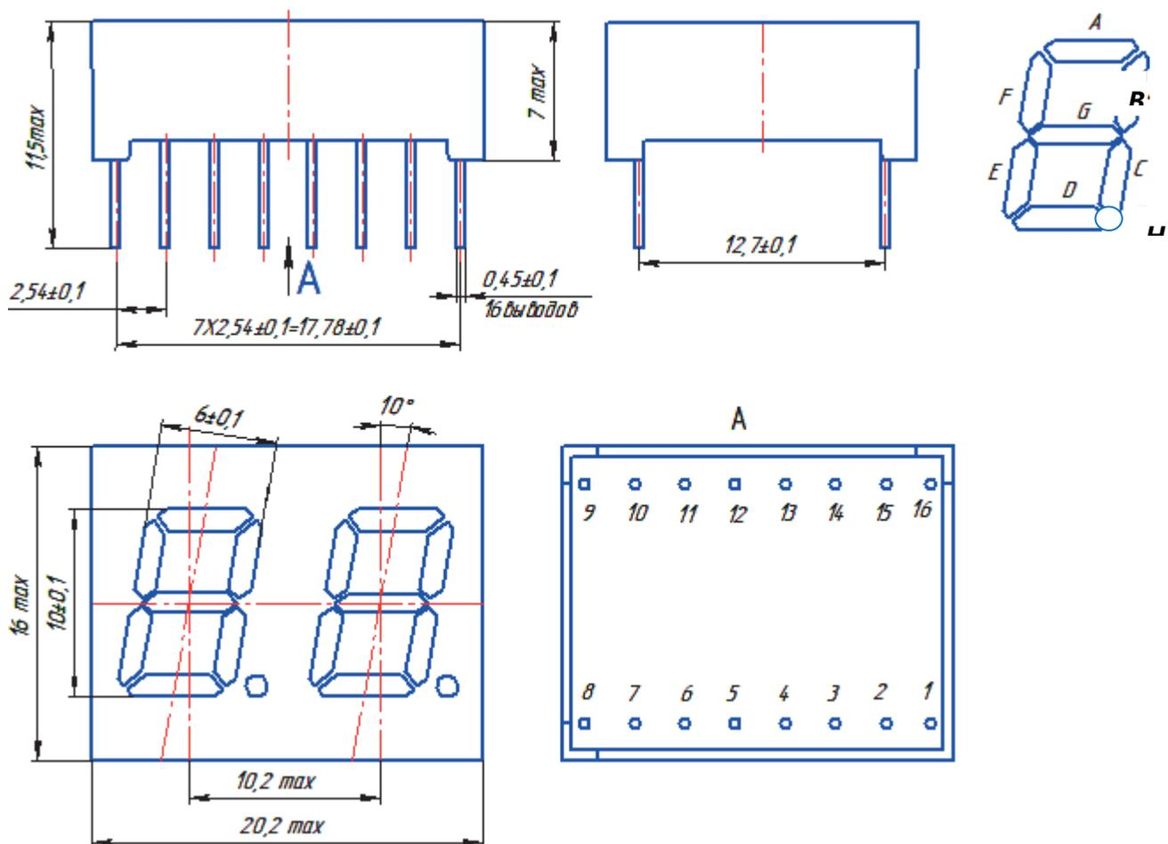
Рисунок 3 – Габаритный чертеж на индикаторы КИПЦ56А-2/7, КИПЦ56А1-2/7
