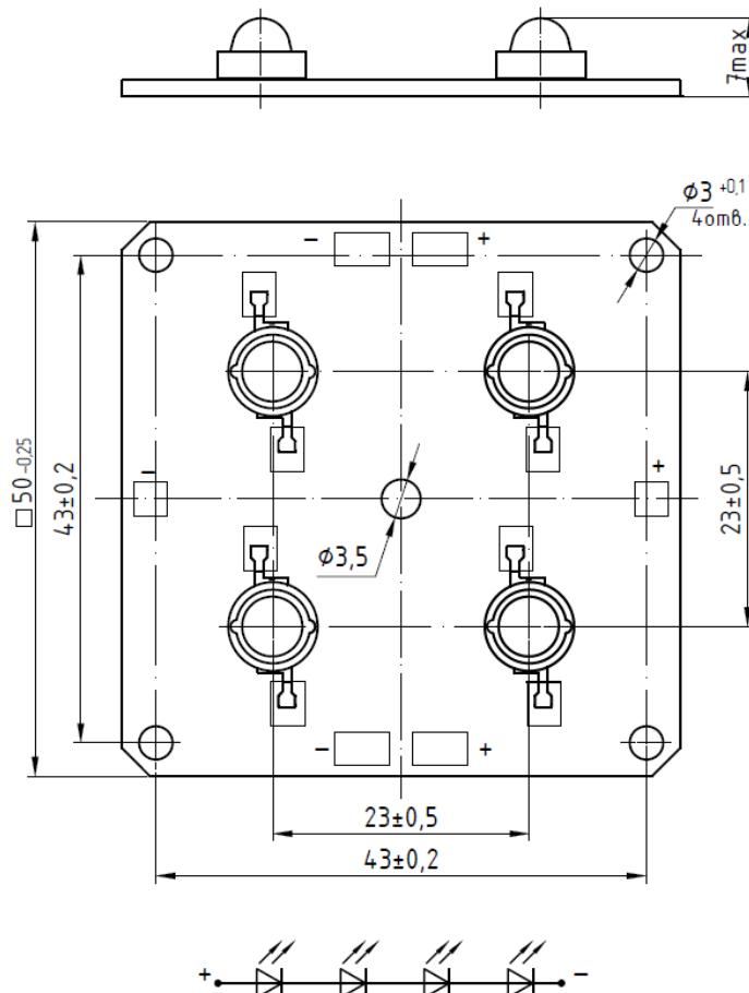
Модули соответствуют КЕНС.435711.005 ТУ. Предназначены для создания излучения инфракрасного диапазона.
